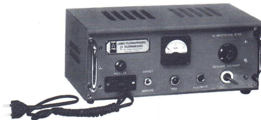
L'alimentation 6 T 50 délivre le courant de chauffage de la cathode du tube TB 7 T3 et la tension d'alimentation (300 V.). Un milliampère-mètre disposé dans le circuit de l'alimentation anodique permet de vérifier que le débit a la valeur désirée. Un potentiomètre permet d'ajuster la valeur de ce courant. Un bouton poussoir "allumage" permet à l'opérateur d'amorcer le tube
