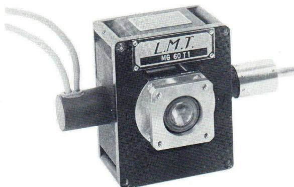
Ce magnétron se caractérise par une stabilité d'impulsion particulièrement élevée (faibles valeurs d'incertitudes de temps, amplitude et fréquence).
