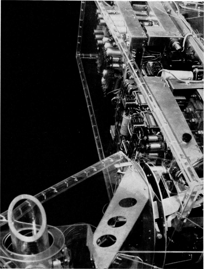
Bovenaanzicht van de romp van het robotdier. Op de voorgrond het „hersenen“-chassis met daaronder de voedingsaccu. Daarachter de triller met trillertransformator, en verder de twee chassis voor de „stereoscopische“ en stereofonische schakelingen (boven) en het radarchassis (onder). Links op de voorgrond is de draaiconstructie van de nek gedeeltelijk zichtbaar.
