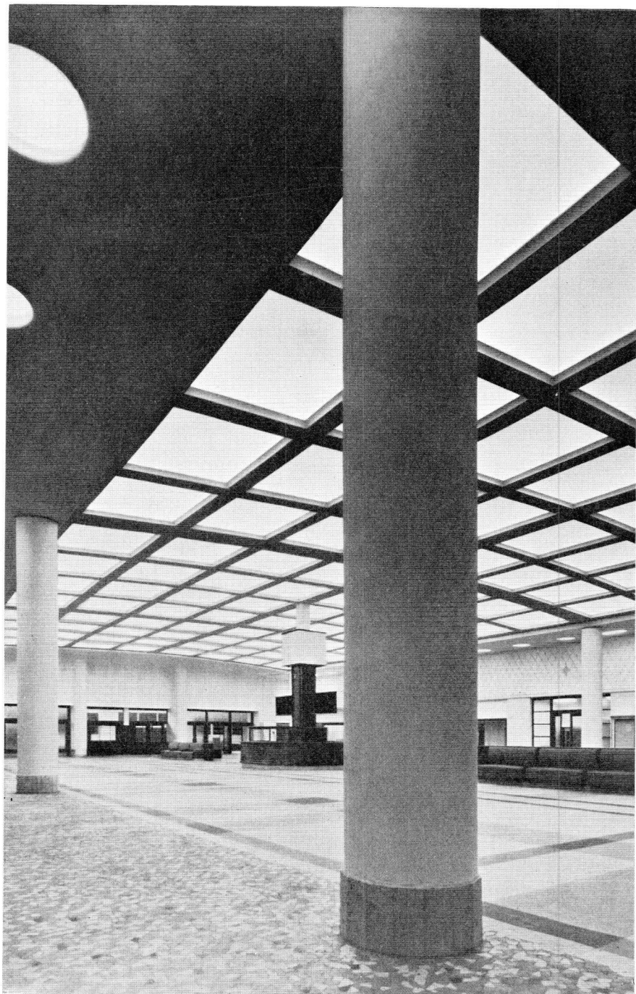
Ontvangsthal luchthavenstation. Indirecte verlichting met TL-buislampen. Verlichtingssterkte 150 lux, lichtstroom 800 lm/m 2 vloeroppervlak.
