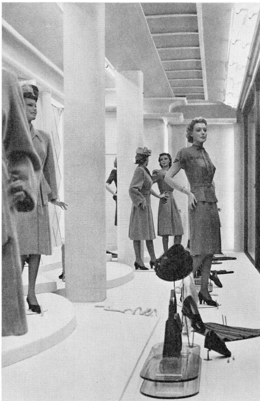
Buislampen TL-40 W in gepolijst metalen reflectoren in etalage voor damesmode-artikelen.
