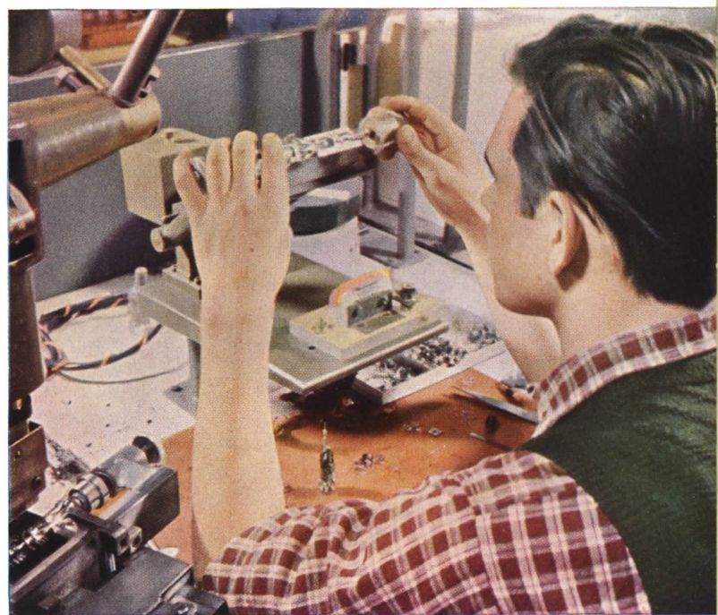
Kleine machines worden benut bij het vervaardigen van de zeer nauw luisterende onderdelen van een televisiebuis.
