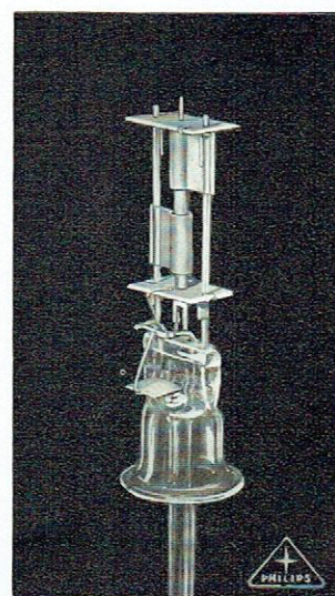
Construction intérieure de la double diode AB 2.
