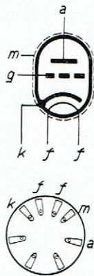
Disposition des électrodes et connexions du culot du tube AC 2.
