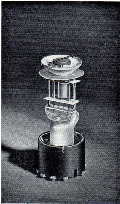
Construction intérieure du trèfle cathodique. Fig. 6
