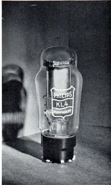
La nouvelle penthode de sortie KL4 pour postes à alimentation par batteries.
