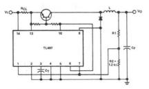
EXTENDED POWER CONFIGURATION (USING EXTERNAL TRANSISTOR)
