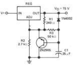
FIGURE 10-SLOW-TURN-ON 15-V REGULATOR CIRCUIT
