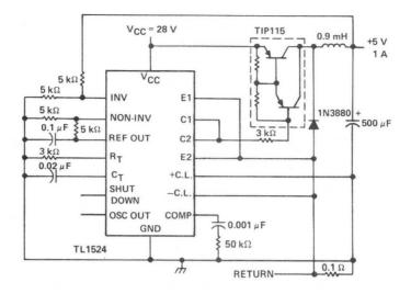
FIGURE 14-SINGLE-ENDED LC CIRCUIT
