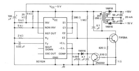
FIGURE 13 - FLYBACK CONVERTER CIRCUIT
