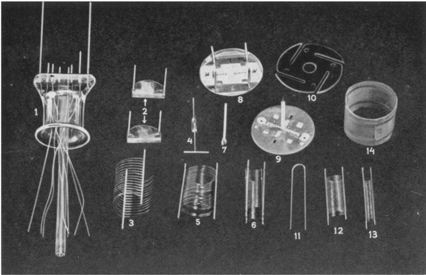
Zusammenlegung der verschiedenen Bestandteile von der Innenkonstruktion der „Miniwatt“-Oktode CK1.
