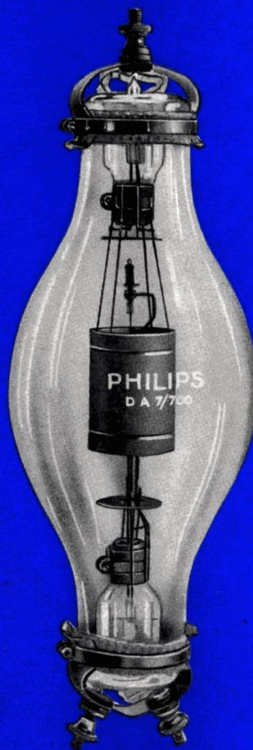
Le tube à vide poussé DA 7/700 a été construit spécialement pour être employé avec le tube émetteur Philips TA 7/700. Il faut alors utiliser au moins deux de ces tubes redresseurs mono-plaques pour obtenir la puissance nécessaire.
