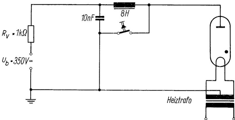
Zur sicheren Zündung der Rauschdiode wird die obige Zündschaltung empfohlen.
