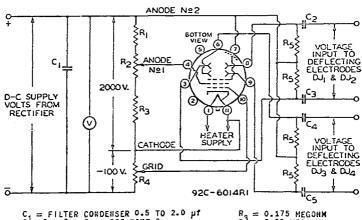
$\rm C_1 = FILTER$  CONDENSER 0.5 TO 2.0  $\mu f$   $\rm C_2$  ,  $\rm C_3$  ,  $\rm C_4$  ,  $\rm C_5 = SEE$  HOTE 2  $\rm R_1 = 0.65$  MEGOHM  $\rm R_2^1 = 0.20$  MEGOHM
